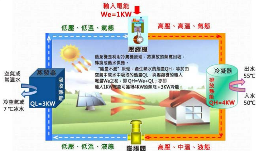
圖 3.1.1 熱泵系統原理 1
